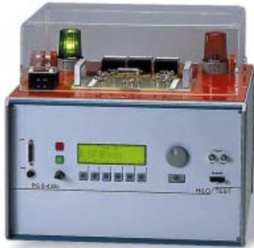
浪涌测试发生器PG 6-432产生标准的脉冲电流波形不通10/700  $\mu$ s 或10/1000  $\mu$ s。此外还可用于two-gap过压保护器的测试。发生器产生两路浪涌电流脉冲输出，每路可调至100KA。脉冲形成网络包含一高精度电流测量电阻以测量输出电流和输出波形的范围。
