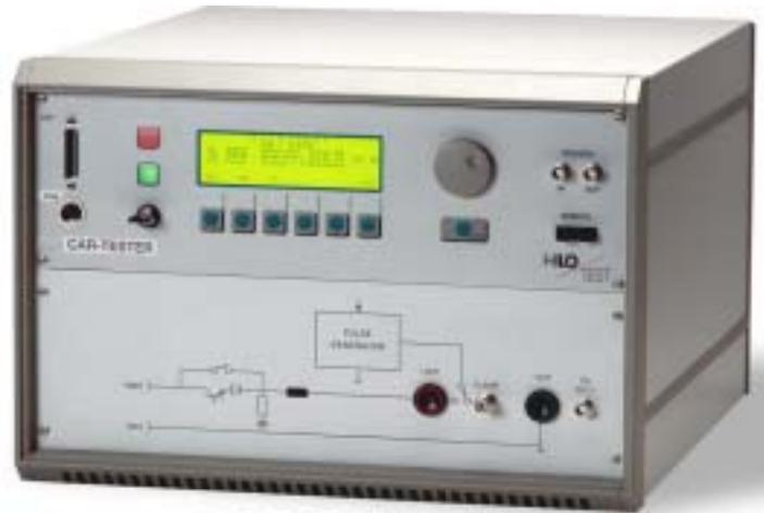
EMC 测试系统，用于交通工具的电气安装的电磁抗扰度测试和元器件对电源线快速瞬变的抗扰度测试。
