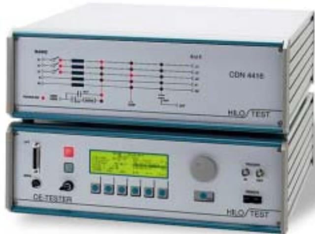
电容性耦合/解耦合网络 CDN 4416/4432 与 CE-TESTER 配合使用,用于将浪涌和脉冲串测试脉冲叠加到待测设备的三相电源中。
