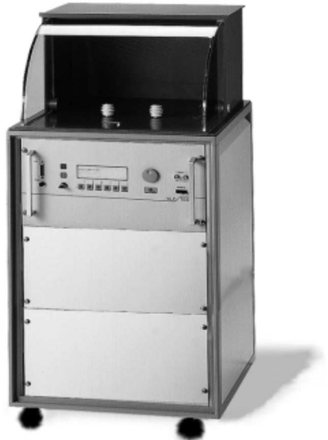
高压输出终端由配以安全互锁装置的介电保护盒保护。一旦保护盒被打开, 发生器自动关闭、或隔离测试目标; 内部储能电容通过内置的高压接地开关放电。
