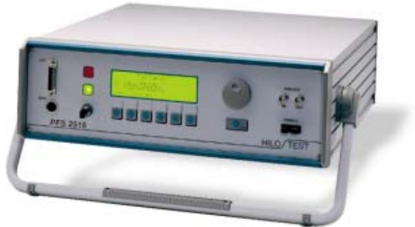
电源故障模拟器 PFS 2516 是一个小巧的测试单元，是为满足 IEC 1000-4-11 所要求的、对电源电压干扰和变化进行电磁抗扰度进行测试而特别设计的。此抗扰度要求是欧洲 EMC 所要求的，同时又是获取 CE 标志的必要的一步。
