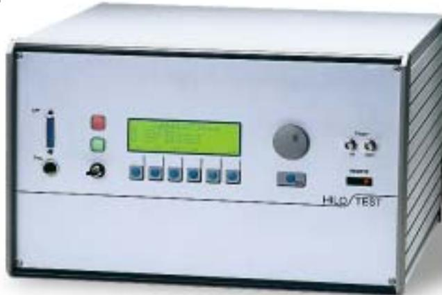
混合波形发生器PG 12-804 是一能够产生冲击电流与冲击电压混合波形发生器。对于高阻抗负载 $R_L > 100\Omega$ ，其输出为标准冲击电压波形1.2/50  $\mu$ s，对于短路输出，冲击电流波形8/20  $\mu$ s。
