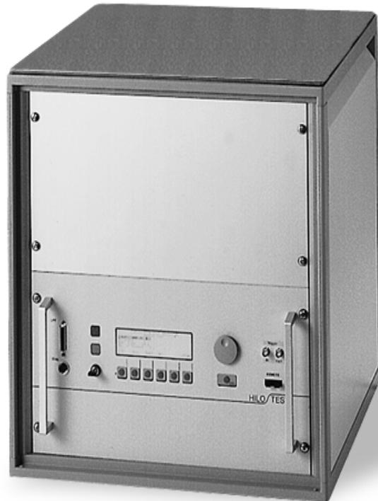
浪涌测试发生器PG 24-2500c为一产生混合冲击电流/冲击电压的发生器。对于高阻抗负载 $R_L > 100\Omega$ ，其输出为标准冲击电压波形1.2/50  $\mu$ s，对于短路输出，冲击电流波形8/20  $\mu$ s，满足IEC 60。脉冲输出电压峰值0.5kV-24kV可调。峰值短路电流幅度12 kA。
