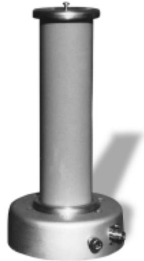
宽带高压分压器HVT...RCR是最先进的测量设备，具有高频传输特性好的特点。高压阻抗由高精度金属薄膜电阻和高压电容以及并联的系列阻尼电阻组成。
