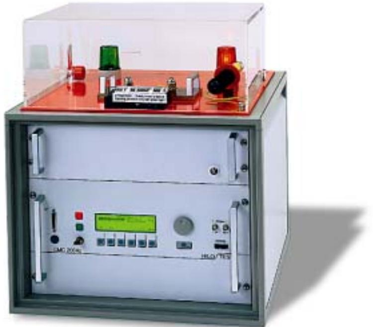
大电流脉冲发生器PG 6-2402主要用于对电气元件、过压保护器和电路的浪涌电流测试，满足IEC, VDE等标准要求。发生器产生标准的冲击电流，波形为8/20 $\mu$ s。脉冲电流输出幅度可以设置为2 - 50 kA。
