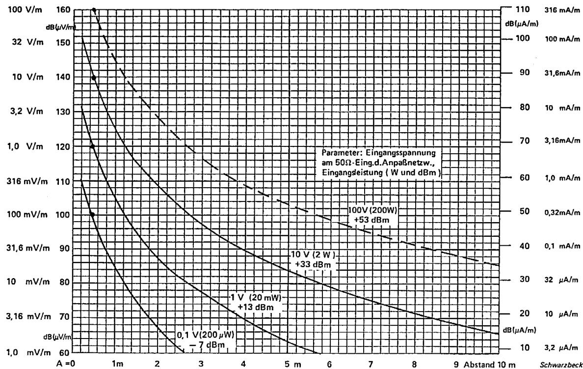
Magnetische Feldstärke einer Sende-Rahmenantenne 0.6 x 0.6 m in Entfernungen von 0.2m bis 10 m, HF-Spannungen 0.1 / 1 / 10 / 100 Veff
