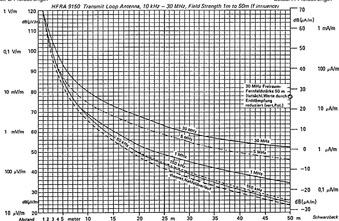
Gemessener Verlauf der magnetischen Feldstärke über Wiesenboden, A=1 m bis 50 m bei Frequenzen von 50 kHz, 150 kHz, 1 MHz, 5 MHz und 30 MHz, 1.5 m über Grund.
