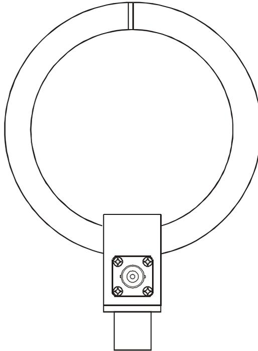
Die Ringantenne für magnetische Felder ist für mittlere und hohe Feldstärken im Frequenzbereich 70 kHz - 120 MHz vorgesehen. Durch die passive Ausführung ist der Einsatz besonders einfach: H-Felder ab 20 dB $\mu$ A/m werden mit Meßempfängern (50  $\Omega$  Eingang, dB $\mu$ V-Kalibrierung ) zur Anzeige gebracht. Zum Spannungspegel in dB $\mu$ V wird das Wandlungsmaß für H-Felder addiert. Das Ergebnis ist die H-Feldstärke in dB $\mu$ A/m.
