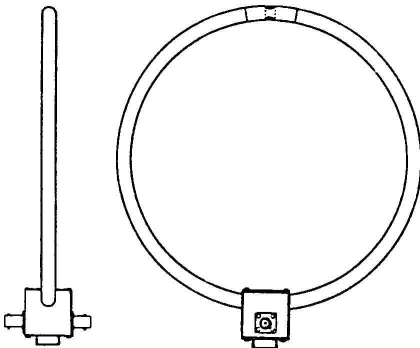
Die Ringantenne für magnetische Felder ist für mittlere und hohe Feldstärken im Frequenzbereich 50 kHz - 30 MHz vorgesehen. Durch die passive Ausführung ist der Einsatz besonders einfach: HFelder ab 20 dB $\mu$ A/m werden mit Meßempfängern (50  $\Omega$  Eingang, dB $\mu$ V-Kalibrierung ) zur Anzeige gebracht. Zum Spannungspegel in dB $\mu$ V wird das Wandlungsmaß für H-Felder addiert. Das Ergebnis ist die H-Feldstärke in dB $\mu$ A/m.
