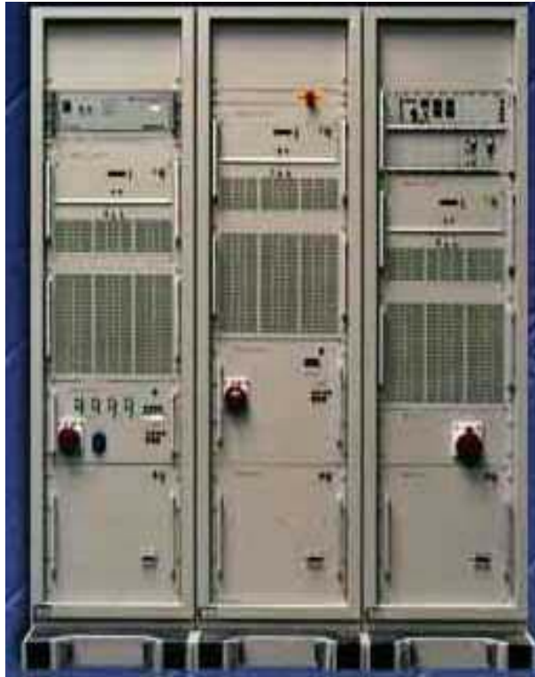
三相谐波和闪烁系统 EMV D 30000 (峰值电流: 3 \times 200A )
